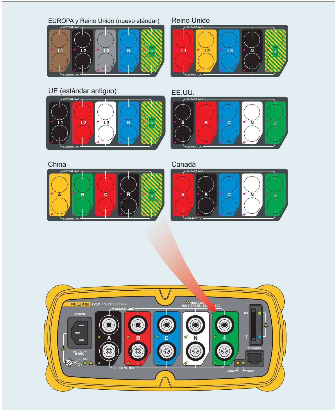
Figura 2. Aplicación de la etiqueta del panel frontal
