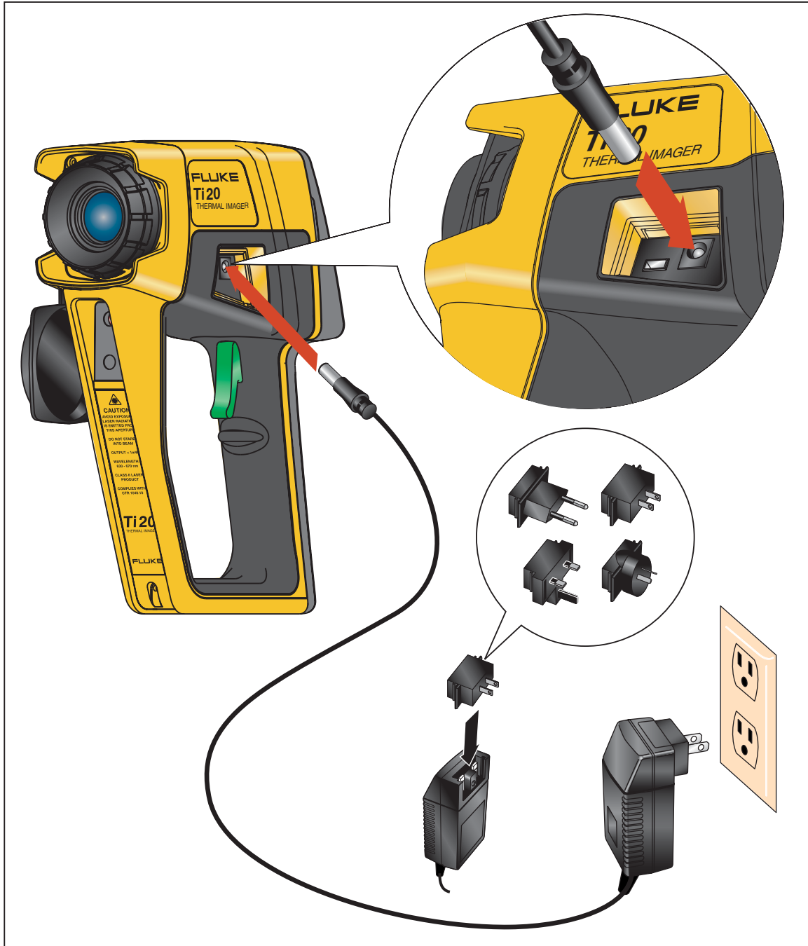
Figura 1-5. Uso del adaptador de alimentación eléctrica
